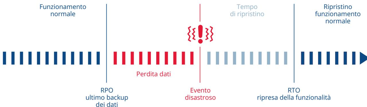
Per garantire tempi di RTO/RPO prossimi allo zero le macchine virtuali sono sempre attive nel cloud con replica in tempo reale delle stesse tra sito di produzione e infrastruttura cloud.
